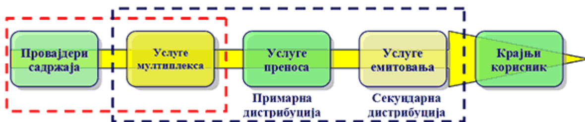
Slika 1. Lanac učesnika u digitalnoj radiodifuziji
