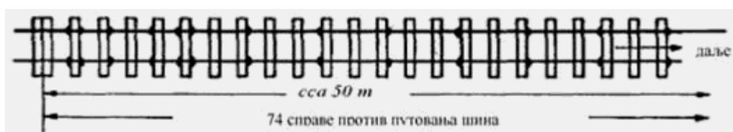
Slika 4: Položaj sprava protiv putovanja šina kod koloseka zavarenog u DTŠ
