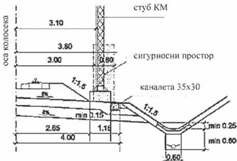
Slika 16b: Kanal za kablove u ivičnoj stazi pored stuba kontaktne mreže
