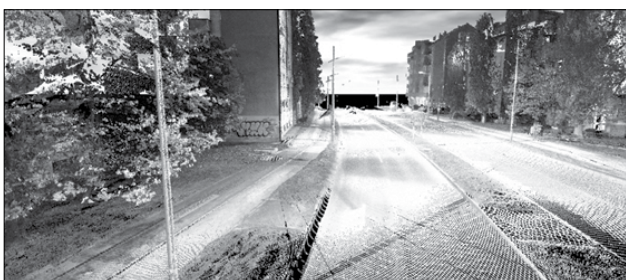
Oblak tačaka dobijen skeniranjem lica mesta FARO FOCUS 3D laserskim skenerom u noćnim uslovima (Šipka N. 2016b.)
